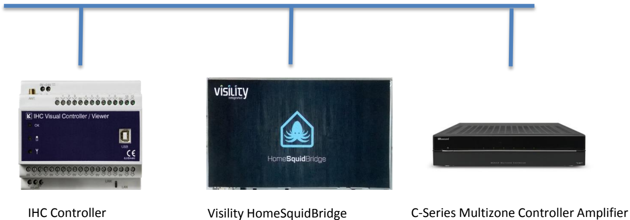
Figur 1: Princip skitse med styring af Russound Multiroom audio.
